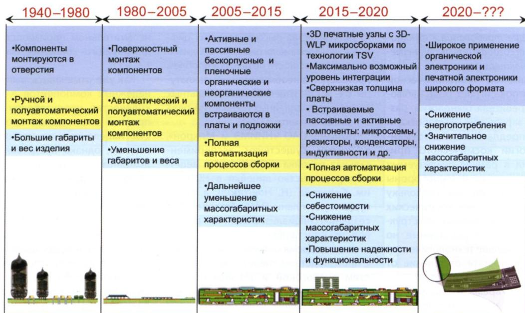
Рис. 2. Развитие технологий сборки и монтажа
