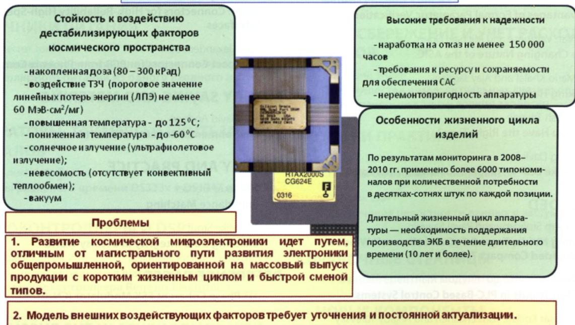
Рис. 1. Специфика ЭКБ для аппаратуры космического назначения
