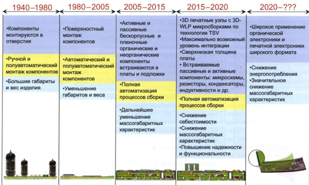
Рис. 2. Развитие технологий сборки и монтажа
