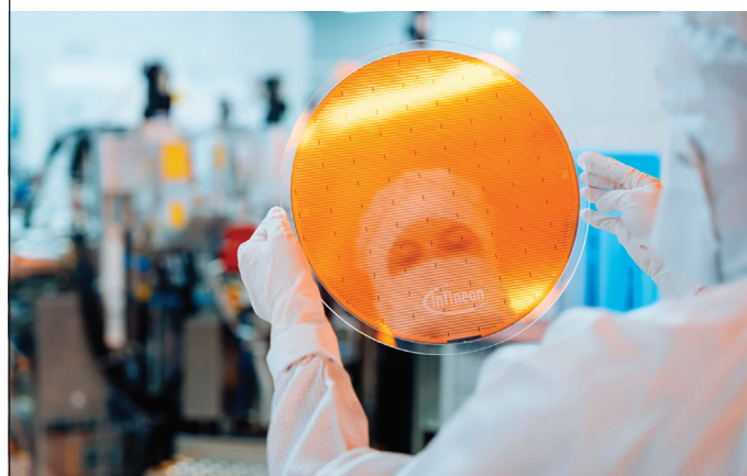
Рис. 12. а) пластины диаметром 300 мм, утоненные до 50 мкм обычным методом и по процессу TAIKO; б) первая в мире пластина силовой электроники диаметром 300 мм, утоненная до 20 мкм, компания Infineon
