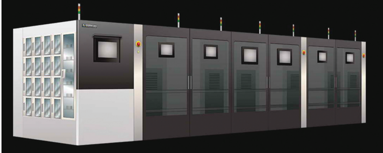
Рис. 4. Автоматическая линия KABRA компании DISCO для разделения слитков SiC на пластины
