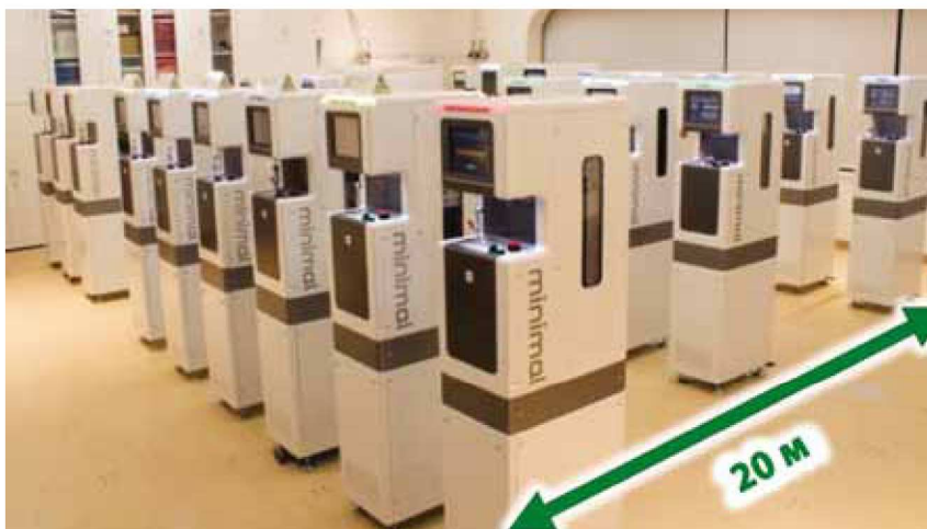
Рис. 1. Оборудование Minimal Fab работает без чистых комнат
