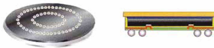
Рис. 3. Корпус WLP BGA является завершающим продуктом Minimal Fab
