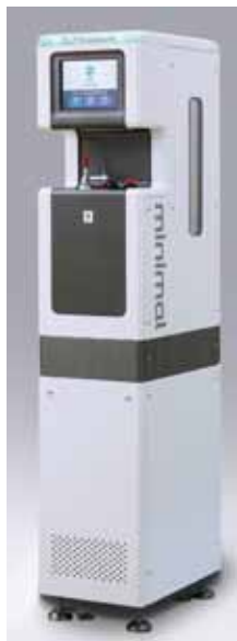
Рис. 7. Пример компактной установки (а) и линии обработки пластин 0,5 дюйма (б) компании Minimal Fab
